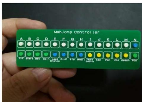
4) カバー基板をかぶせてみて、タクトスイッチにズレがないか。浮きがないか確認します。
