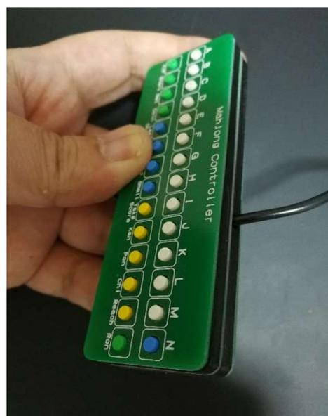
6) スペースを使ってカバー基板を両面テープで張り付けて完成です。両面テープはなるべく強力な物を使って下さい。閉じる前に、正常に動作するか確認することを推奨します。
