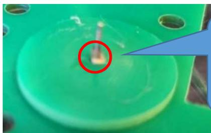
はんだ付け後、適当なリード線の被覆を2mmくらいにカットして挿入します。
