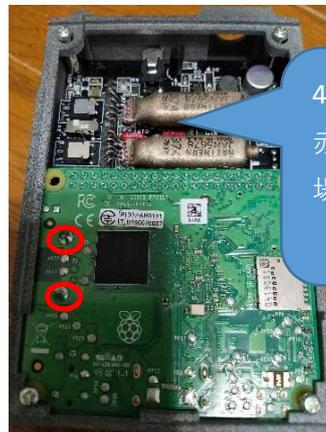
4か所の2.6mm x 10mmねじを外します。赤丸2か所のUSBのツメが裏ブタにあたる場合、カットしてください。
