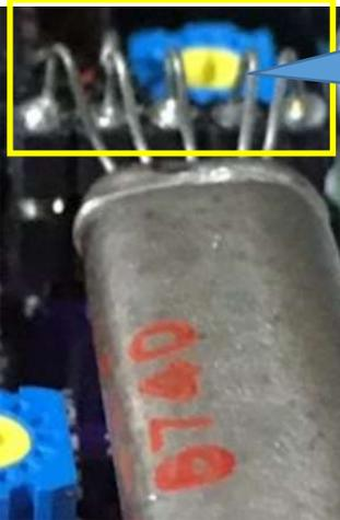
足をフォーミングして、ピンソケットに刺してはんだ付け。こうすることにより、基板のピンソケットに抜き差ししやす
