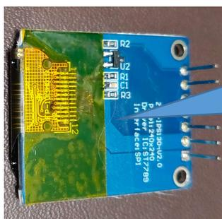
ピンヘッダをはんだ付けし、黒いプラスチックを取り除く。液晶フレキ部分を絶縁します。
