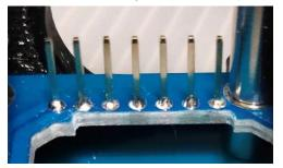
黒いパーツを先の液晶の加工の時とおなじように、ニッパー等で持ち上げて外します。
