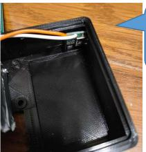
マイクロUSB端子をケースにはめ込みます。 固くて入らない場合は、すこしマイクロUSB基板を 削ってください(削りすぎ注意)
