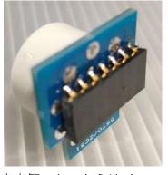
真空管ソケットを挿入。基板面ツライチカットの上、はんだ付けします。
