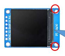
基板の赤丸部分をカット(ニッパーなどで)して、基板を写真のように短くします。
