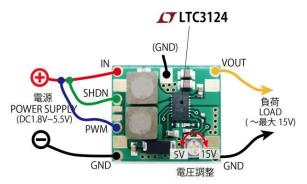
SHDN,PWMは、すべて+側にショートしておきます。 はんだブリッジするなどで、適当にショートしてください。 デフォルトとして6Vを推薦します 設定電圧ごとに、R1の値が異なります。(以下参照)  $5.7V=43\Omega,\,6V=68\Omega,\,6.3V=100\Omega,\,7V=150\Omega$  (6.3Vの球を5.7Vで使うとギリギリ定格内ですし、 電池の持ちがよくなります)
