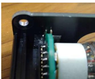
真空管ソケット基板の厚さに合わせて、フロントパネルのソケット揺れどめを微調整をしてください
