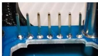
・真空管ソケットうけピンヘッダーの実装
