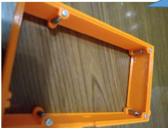
11mmのスペーサーを2.6mmx15mmのネジで「ゆるく」仮止めしておきます
