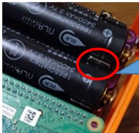
バッテリーのプラス側の電池金具を、お互いが接触しても平気なようにテープなどで、絶縁をおこなってください。
