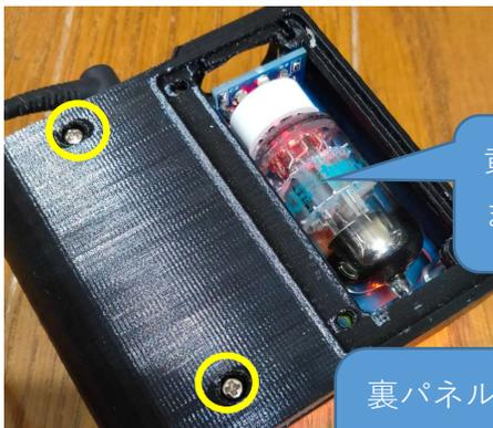
黄○部分を、2.6x5mmねじで固定し、真空管を挿入します。
