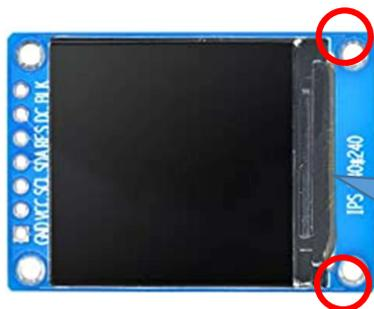
基板の赤丸部分をカット（ニッパーなどで）して、基板を写真のように短くします。
