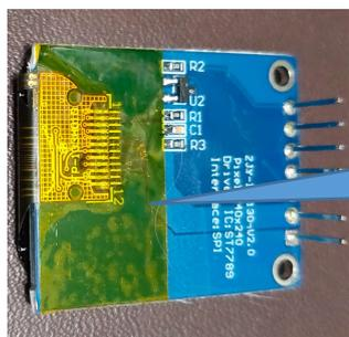
ピンヘッダをはんだ付けし、黒いプラスチックを取り除く。液晶フレキシ部分を絶縁します。
