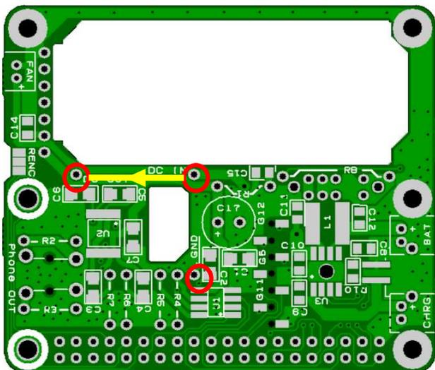
赤丸部分に1P丸ピンソケットを実装し、DCDCコンバータを抵抗などのリードを使い接続します。
