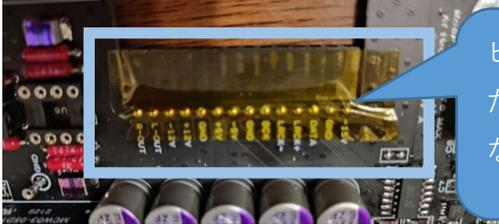
ピンは曲げて挿入。基板面ツライチカットの上、絶縁してください。
