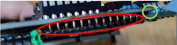
DACとMAXの接続コネクタ（赤丸）は、DACとMAXの間に隙間（緑丸）が少しできるように浮かせ気味にしてください。
