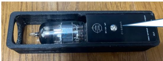
真空管を引き抜き、リアパネル（電源スイッチがないほう）のネジを取り、パネルをはずします。
