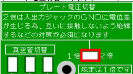
プレート電圧は12V (1倍) ですが、これを24V(2倍) に切り替えることができます。ただし24V(2倍) は、IN、OUTジャックに電位差が生じ、接触するとスパークし危険です。
