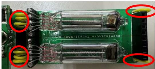
組み立てた各基板を結合していきます。球基板とメイン基板の結合です。黄色線（赤丸）部分を、AWG28くらいの柔らかいワイヤーで接続します。
