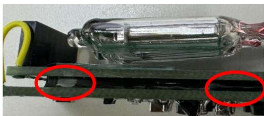
メイン基板との球基板の貼り合わせは粘着ゲルを用品です。粘着ゲルの厚さは3mm-4mmくらいにします。2mmの粘着ゲルであれば2枚重ねにしてください。全体に貼り付ける必要はなく、赤丸部分のように、前後2箇所などOKです
