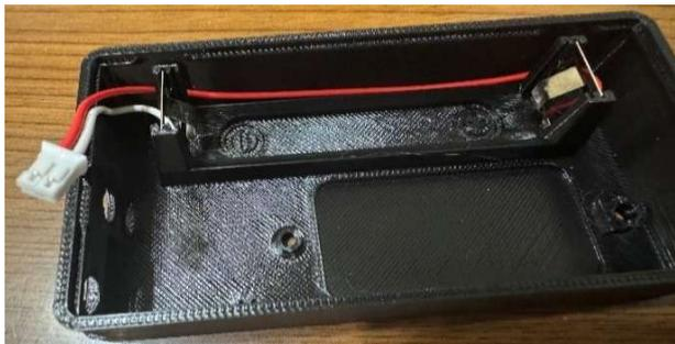
18650電池フォルダーから、金具だけ抜き取って、線付きPHコネクタにはんだ付け。写真のように専用ケースにさしこんでください。
