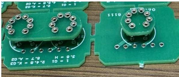
6111およびEF73真空管は、付属の穴あき基板に丸ピンソケットを刺してガイドとし、写真のように使ってください。
