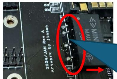
MAU101は、赤丸のシルク部分より右側（矢印方向）になるように設置してください。本体側のDCDCとのクリアランスが確保できなくなります。
